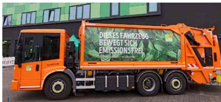
Die neueste Anschaffung ist ein E-Abfallsammelfahrzeug. Der Antrieb ist vollelektrisch, Presswerk und Lifter funktionieren elektrohydraulisch.
